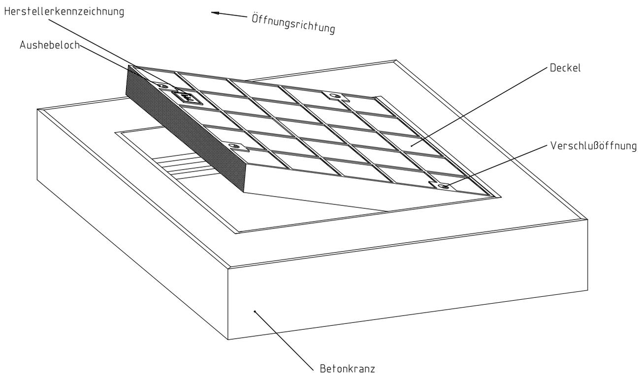
Die Schachtabdeckungen haben, konische, mechanisch bearbeitete Auflageflächen. Dadurch wird ein saugender Sitz des Deckels im Rahmen erreicht. Die Schachtabdeckung ist dann in Verbindung mit einem Fettfilm tagwasserdicht. Die Deckel werden in einer genau definierten Richtung und nur mit speziellen Aushebestangen ausgehoben. Dadurch wird zusätzlich eine Sicherung gegen unbefugte Nutzung erreicht.
